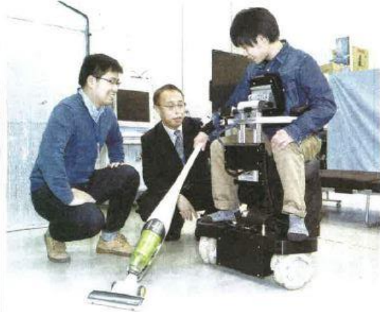
歩行ロボットに乗って楽々お掃除。障害などで歩けない人の生活を支援するロボットの研究に、高知工科大学(香美市土佐山田町宮ノ口)の王碩玉教授(54)らが取り組んでいる。乗っている人の上半身の動きから作業意図を読み取り、移動したり椅子が上下したりするシステムを開発。実用化を目指し改良を重ねている。(門田朋三)
